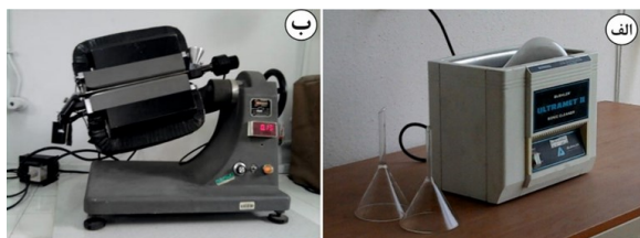
شکل ۱- تصویر دستگاه اولتراسونیک (الف) و تصویری از دستگاه Frantz magnetic separator مدل L-1 جهت جدایش مغناطیسی کانیها.
